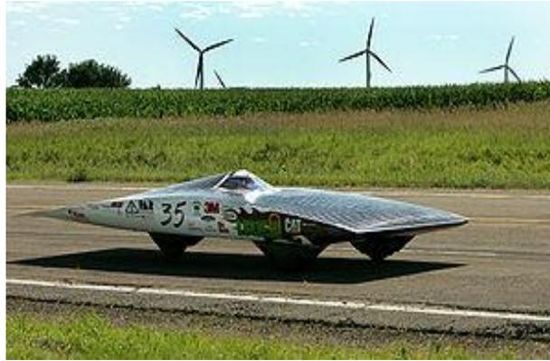
يتم تثبيت ألواح الخلايا الشمسية على سطح السيارة الشمسية، وتقوم باستقبال أشعة الشمس وتحويلها إلى طاقة كهربائية. تمر هذه الطاقة خلال دوائر تحكم وتنظيم للتيار الكهربائي بما يناسب المحرك الكهربائي الذي لا صوت له.
